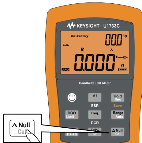
Figure 2-18 Utilisation de la fonction Null
