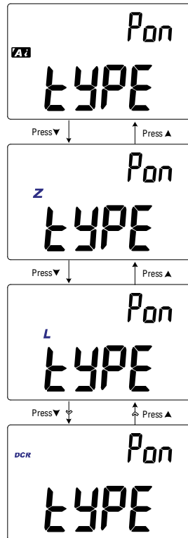
Figura 3-1 Modifica del tipo di misurazione all'accensione
