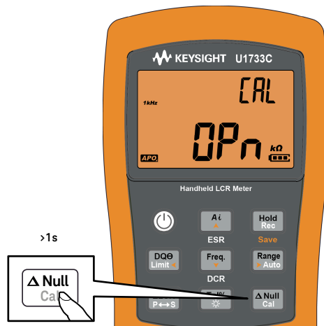
Figure 2-19 Utilisation de la fonction Cal
